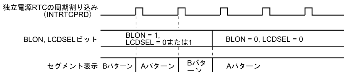
図24-15 点滅表示からAパターン表示への切り替え動作
