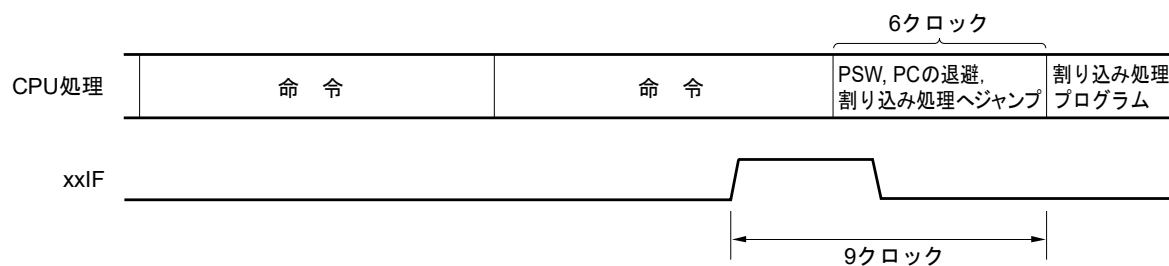
図27-8 割り込み要求の受け付けタイミング（最小時間）
