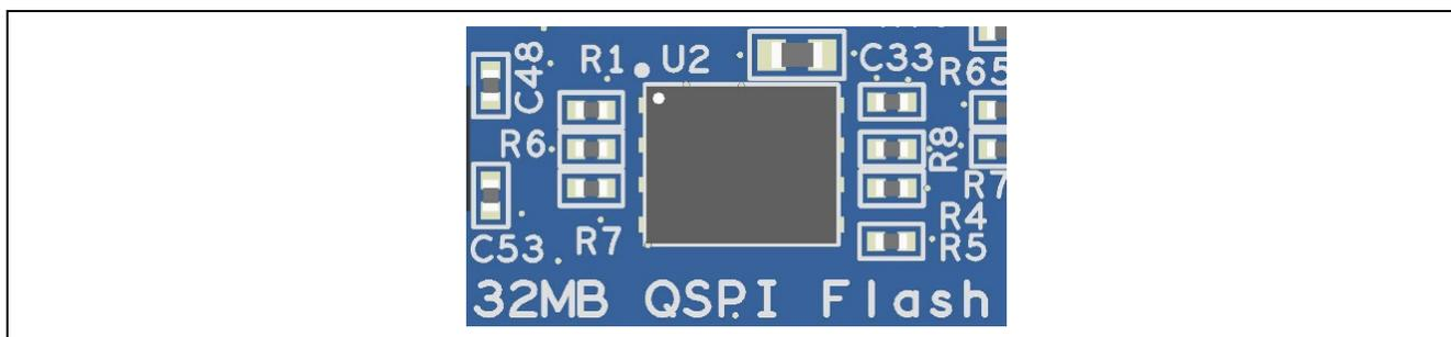
**Figure 24. Quad-SPI Flash**
