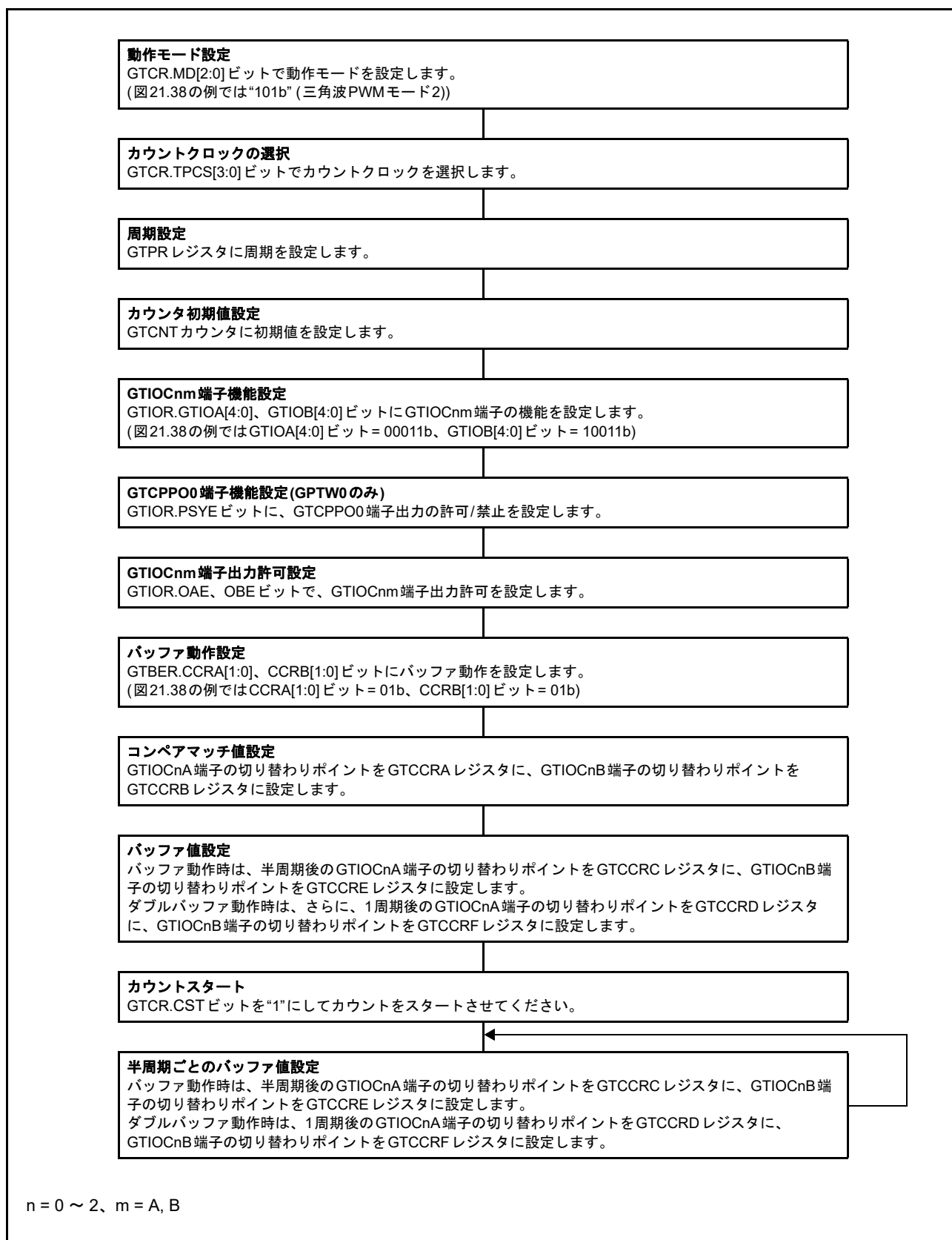
図 21.39 三角波 PWM モード 2 設定例
