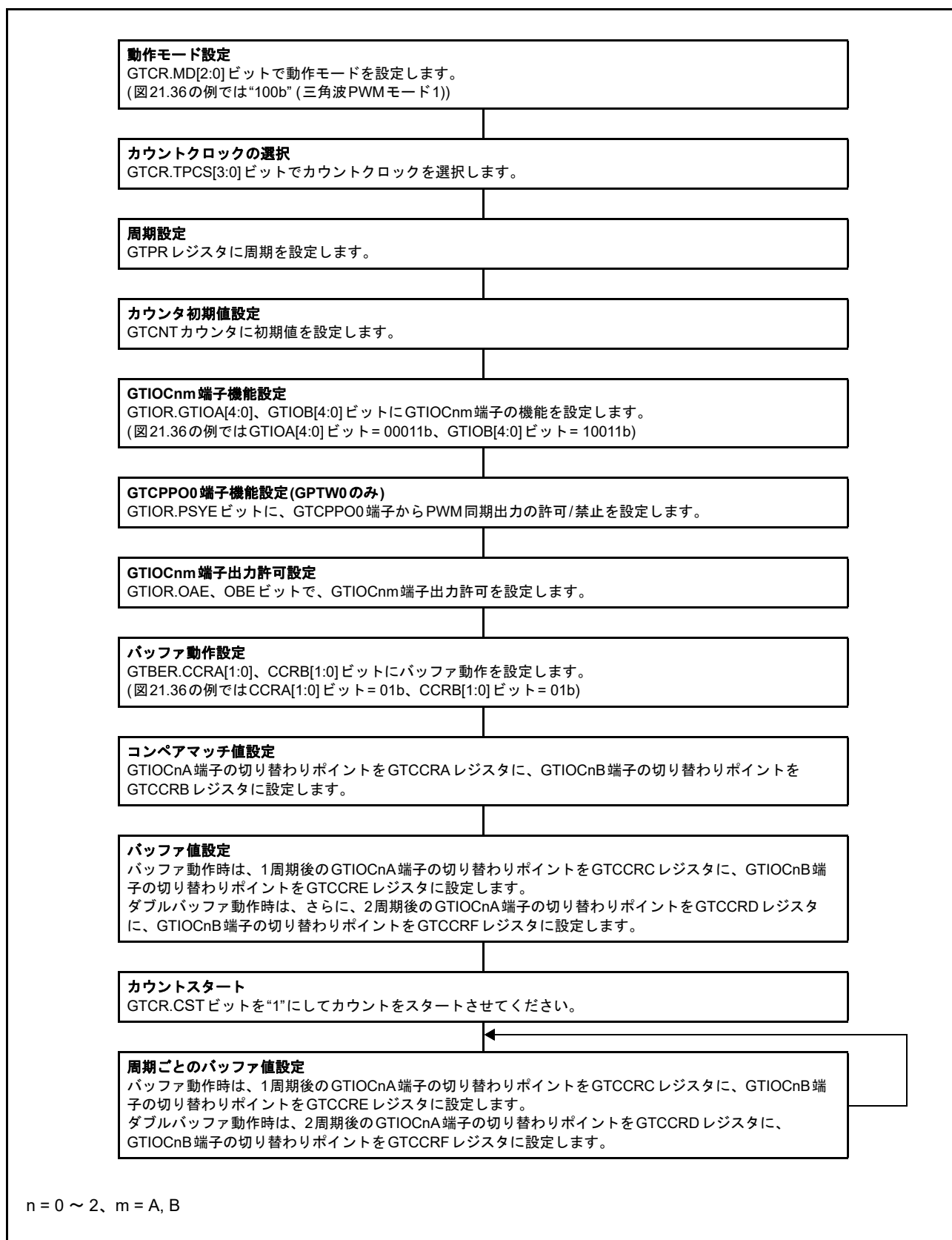
図 21.37 三角波 PWM モード 1 設定例
