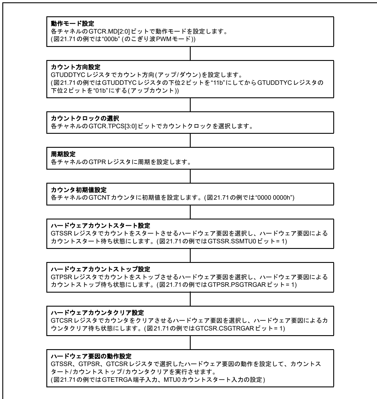
図 21.72 ハードウェア要因による同時スタート設定例
