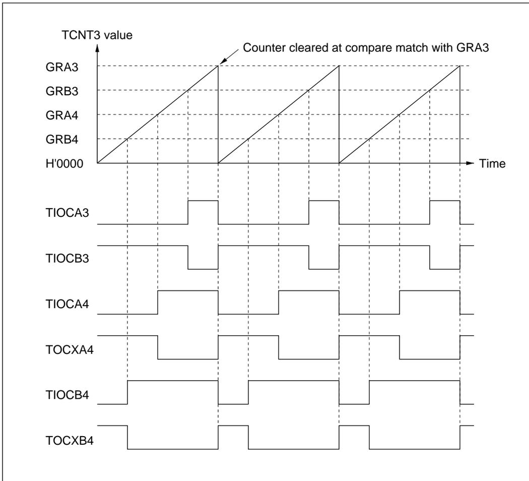
**Figure 10-32 Operation in Reset-Synchronized PWM Mode
