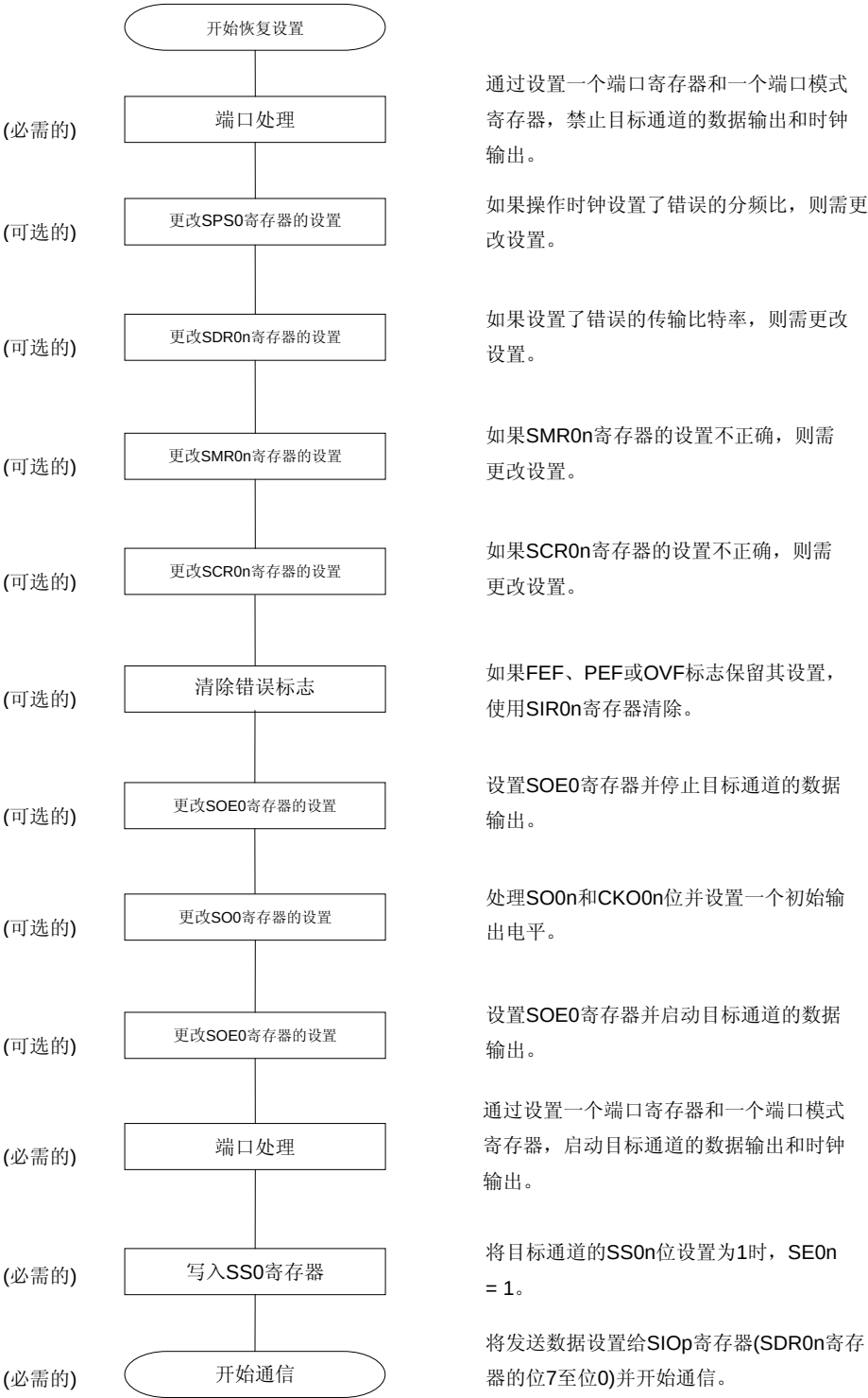
图 12-26. 恢复主机发送的步骤
