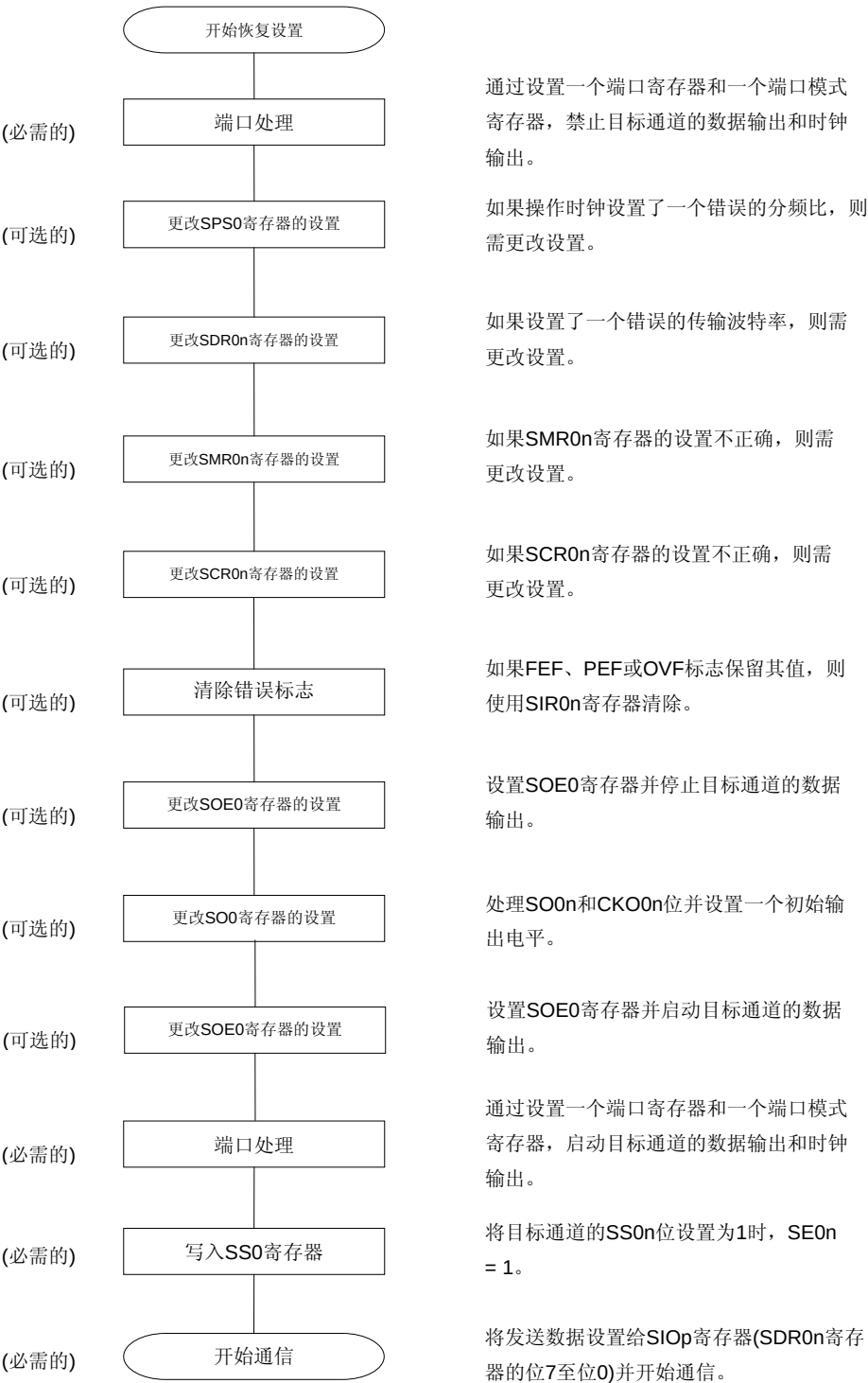
图 12-40. 恢复主机发送/接收的步骤
