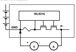
FIGURE 9. CHARGE OVERCURRENT TEST CONNECTION
