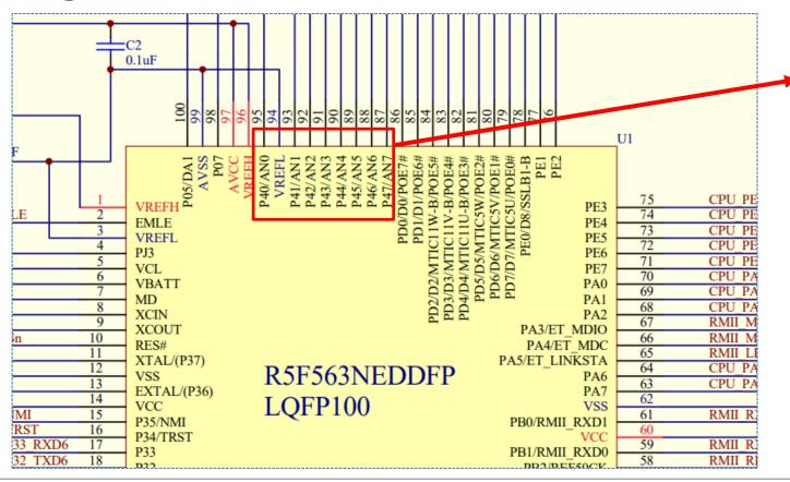
P40/AN000 P41/AN001 P42/AN002 P43/AN003 P44/AN004 P45/AN005 P46/AN006 P47/AN007
