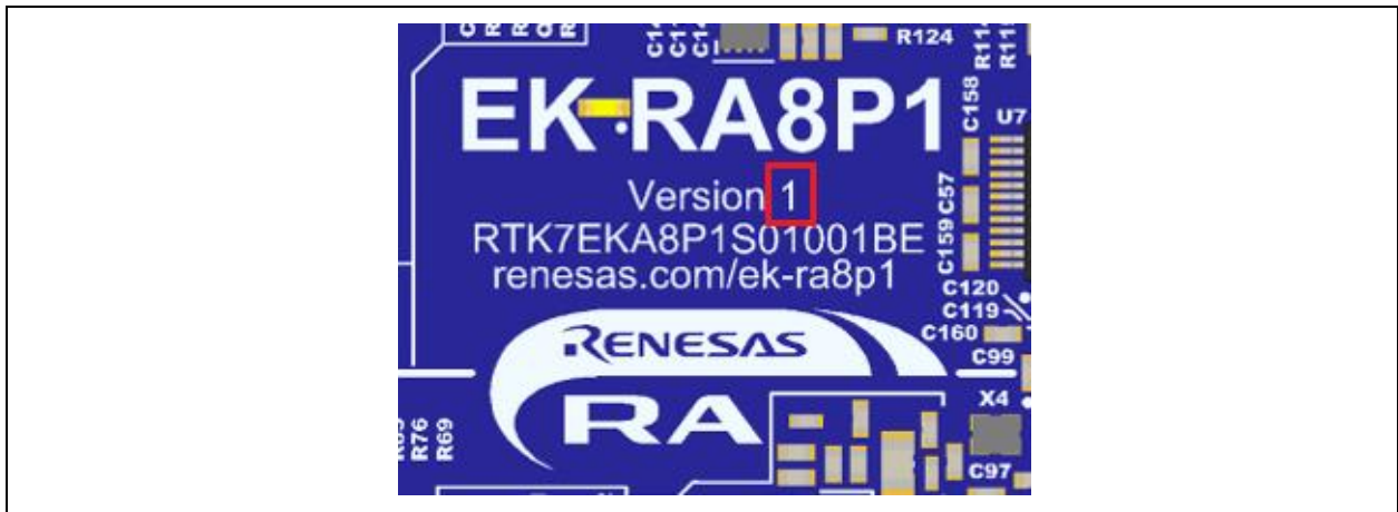
図 6 EK-RA8P1 ボードのキットバージョンナンバーの識別
