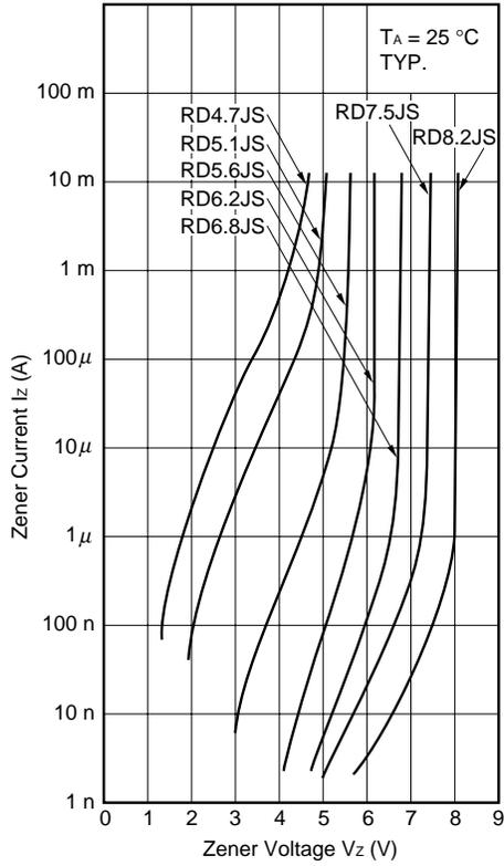
Fig. 2  $I_z$ - $V_z$  CHARACTERISTICS
