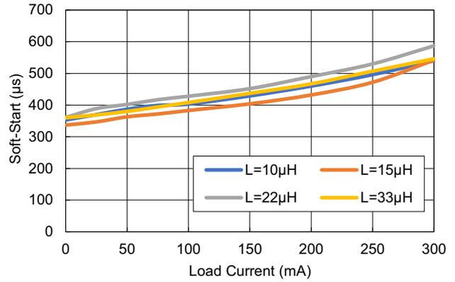
Figure 40. Soft-Start ( $V_{IN} = 24V$ ): RAA211805
