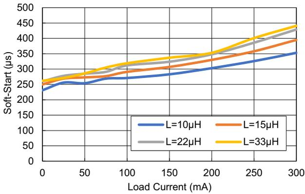
Figure 39. Soft-Start ( $V_{IN} = 24V$ ): RAA211803
