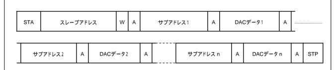
【注】 開始条件の後、スレーブアドレスによってICにアクセスし、サブアドレスとDACデータの2バイトで 各チャネルにデータ転送します。
