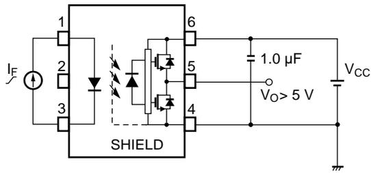
图8 t<sub>PLH</sub>, t<sub>PHL</sub>, t<sub>r</sub>, t<sub>f</sub> 測定回路と波形
