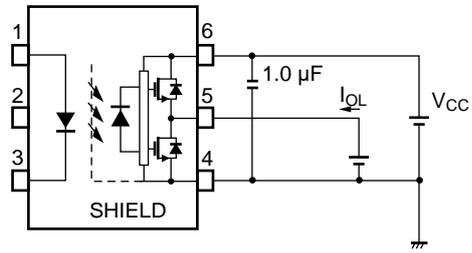
図3  $V_{OH}$  測定回路
