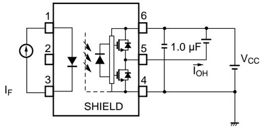
図2  $I_{OL}$  測定回路
