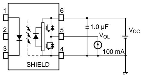
図5  $I_{CCH}/I_{CCL}$  測定回路
