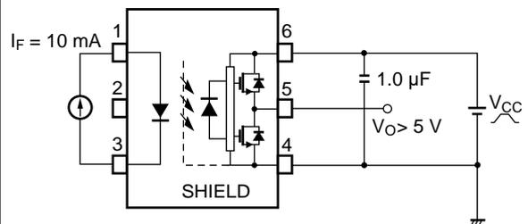
图7 I<sub>FLH</sub> 測定回路
