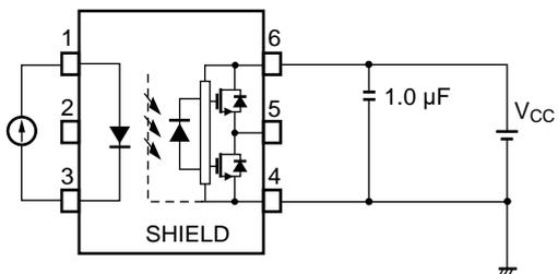
図6 UVLO測定回路
