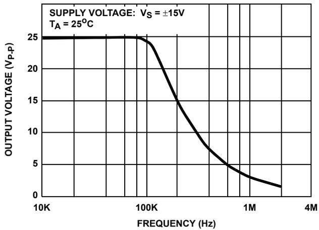
FIGURE 16. MAXIMUM OUTPUT VOLTAGE SWING vs FREQUENCY
