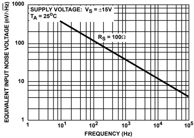
FIGURE 18. EQUIVALENT INPUT NOISE VOLTAGE vs FREQUENCY
