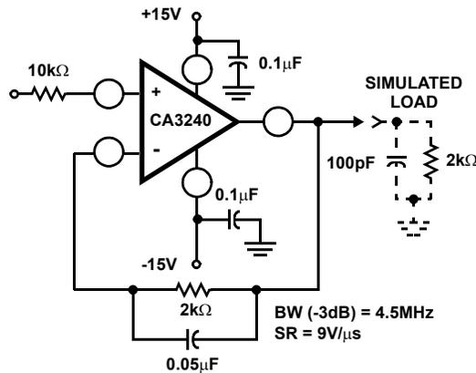
**FIGURE 1C. TEST CIRCUIT**
