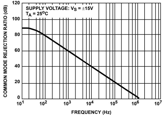
FIGURE 17. COMMON MODE REJECTION RATIO vs FREQUENCY
