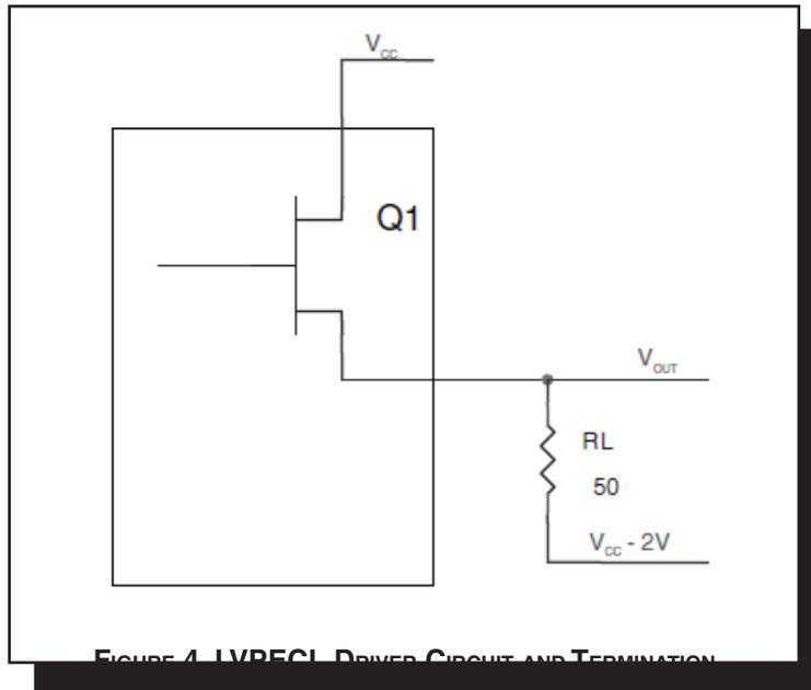
FIGURE 4. LVPECL DRIVER CIRCUIT AND TERMINATION
