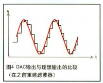
DAC输出波形将通过模拟重建滤波器尽可能多地消除这类不必要的频率。如果时钟抖动和相位噪声边缘可以很好地控制,滤波器的设计将更加容易,实现成本也较低。除了采样时钟在特定偏移条件下的具体位噪声水平要求,还有一个频率范围内集成RMS抖动的规范。这是由于时钟抖动造成理想输出波形的畸变。这将降低DAC的总谐波失真(THD)或信噪加失真比(SINAD),必须保持在规范
