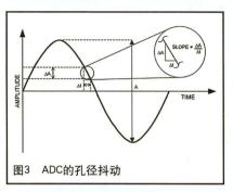
其基本概念是,任何时间不确定性的采样都可以通过三角法转换成该采样振幅的不确定性。振幅的不确定性可导致ADC信噪比的下降。一旦已知了输入信号的频率,RMS抖动目标可确定为ADC的理想信噪比。一旦达到目标,ADC内的时钟树固有抖动即可分解出来,以确定采样时钟的目标RMS抖动规格。
