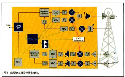
献,它可以推动时钟信号超出规范。 有了这种集成,不仅可产生射频与中 频调制时钟,而且可以产生ADC和 DAC的采样时钟及其他数字元件时 钟,如CPU、ASIC和FPGA。
