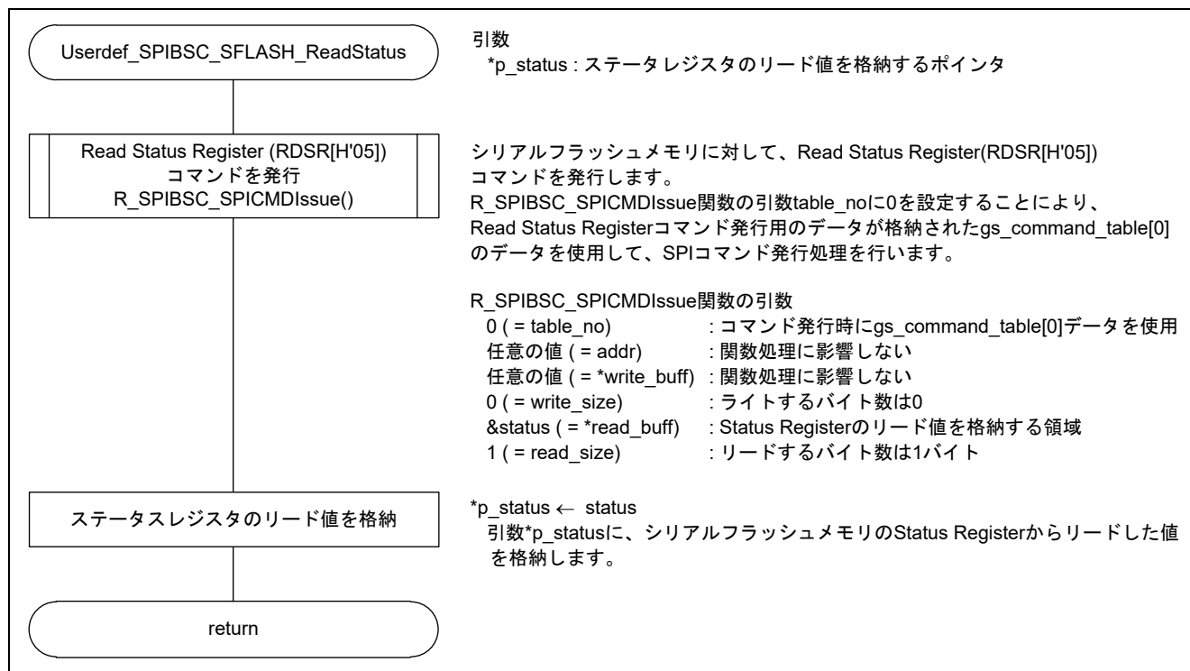
図6.9 Userdef_SPIBSC_SFLASH_ReadStatus 関数のフロー
