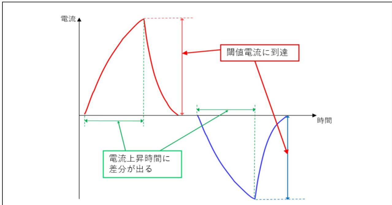
図 3-19 電流印加方向による電流差異
