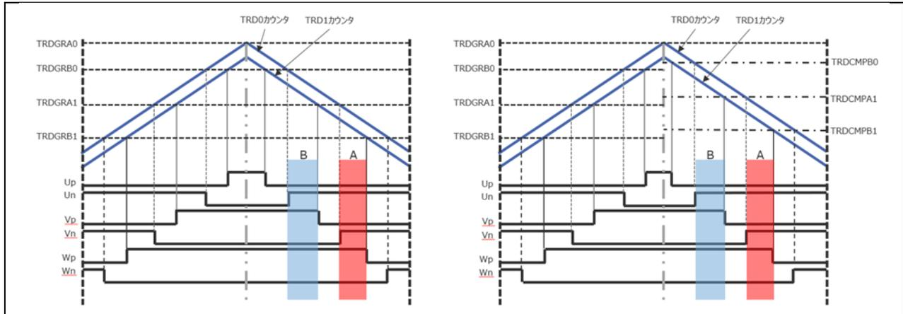
図 3-10 A/D 変換タイミング
