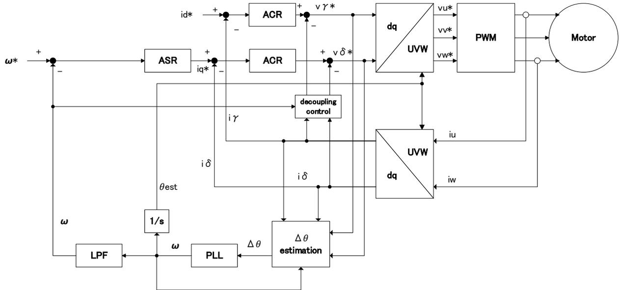
図 3-7 制御システムブロック図
