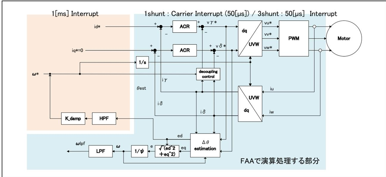
図 3-22 制御ブロック内の割り込み処理(オープンループ制御時)
