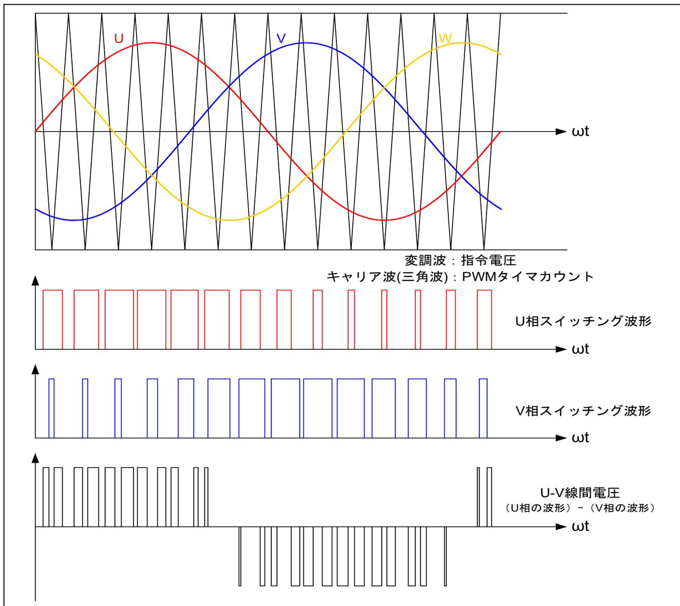
図 3-3 三角波比較法の概念図
