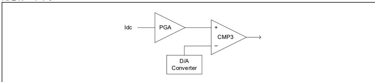
図 3-1 CMP3 による過電流検出
