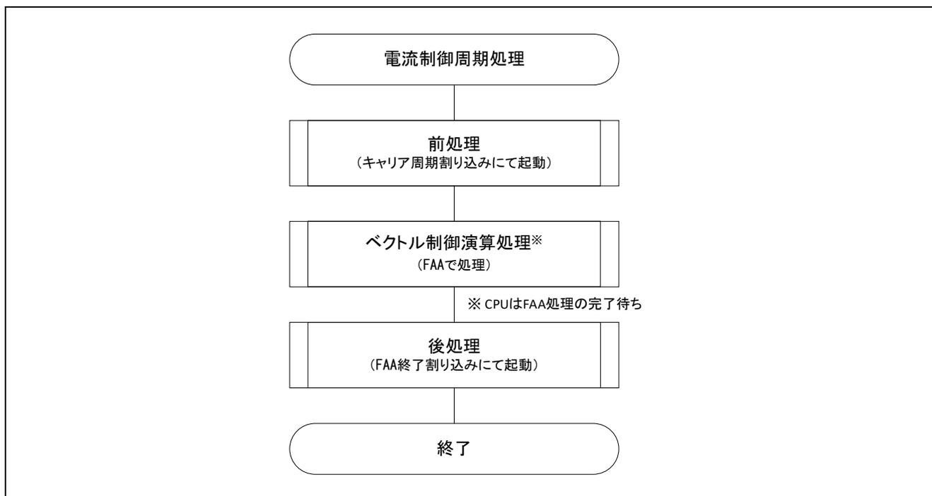
図 3-26 電流制御周期処理フローチャート
