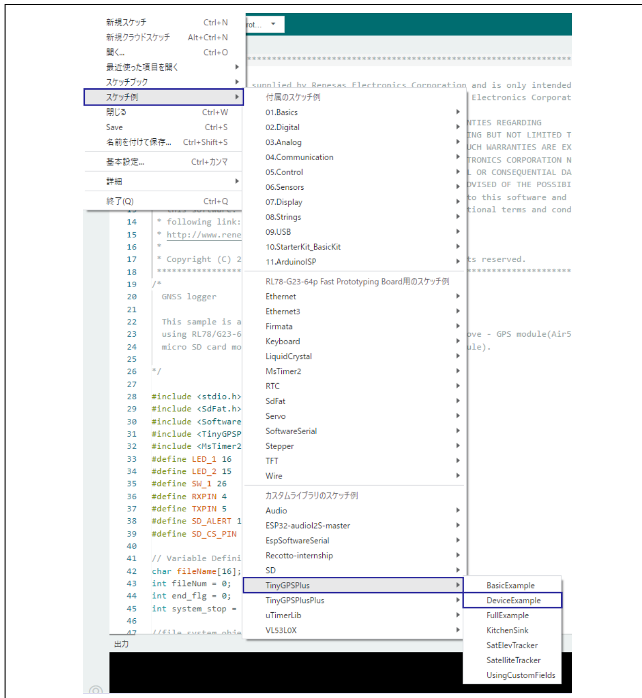
図 4-7 TinyGPSPlus / DeviceExample の選択
