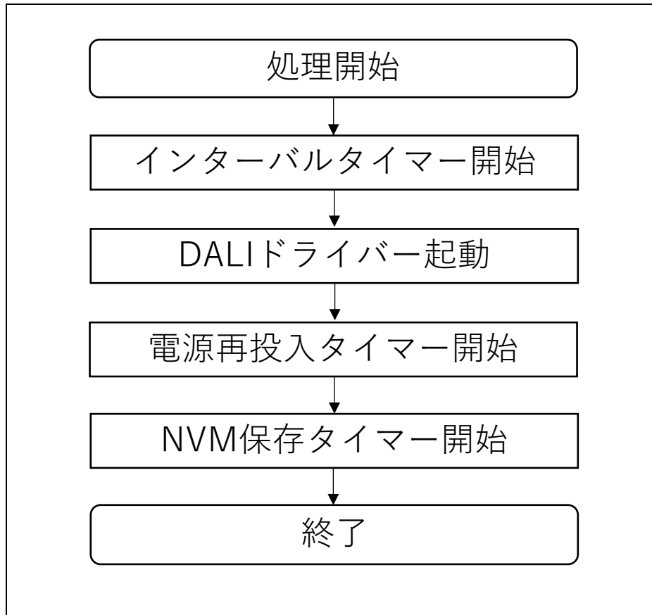
図 4-16 処理開始フロー図
