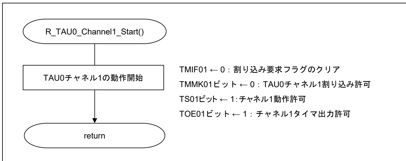
図 5.17 TAU0 チャンネル 1 動作開始処理関数
