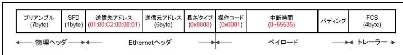
図 1-4 PAUSE フレームのフレーム形式
