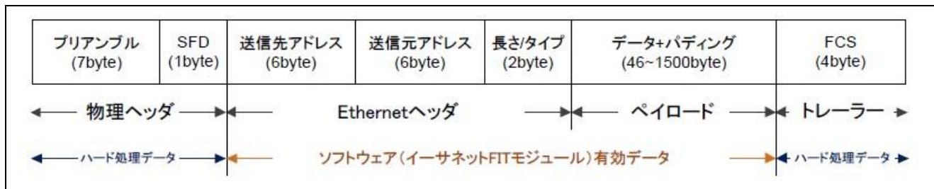
図 1-3 Ethernet II /IEEE802.3 のフレーム形式
