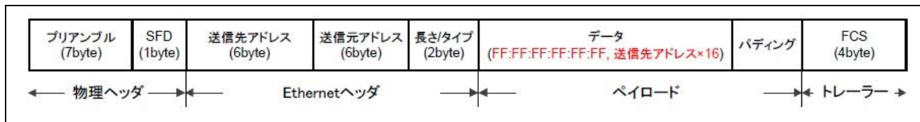
図 1-5 マジックパケットのフレーム形式
