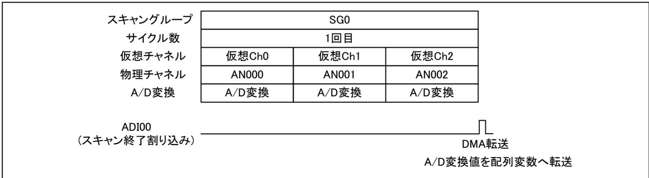
図 3-34 DMA 転送を使用した動作例
