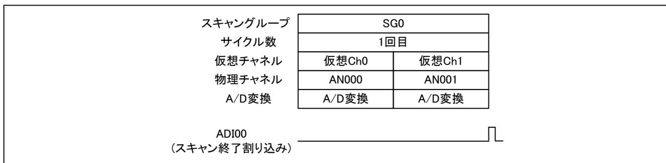
図 3-1 通常 A/D 変換 (マルチスキャン) 動作
