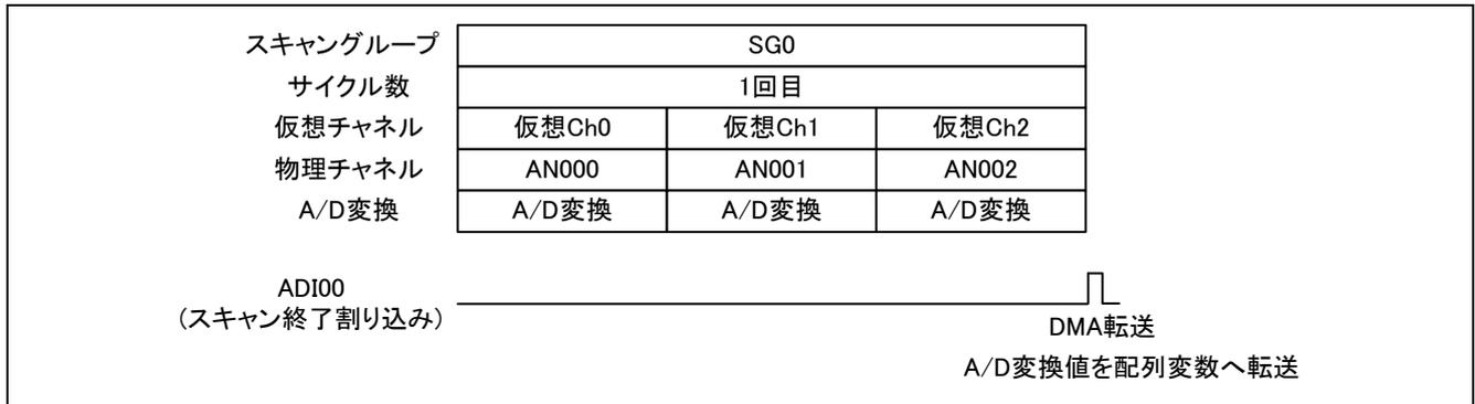
図 3-29 DMA 転送を使用した動作例
