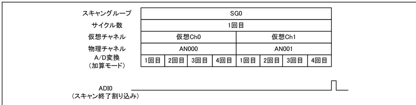
図 3-17 加算モードを使用した通常 A/D 変換動作
