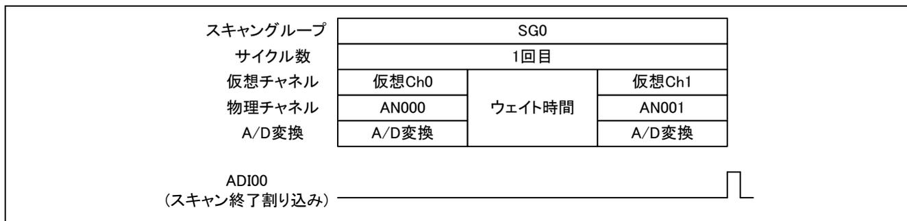
図 3-39 通常 A/D 変換 (マルチスキャン) 動作
