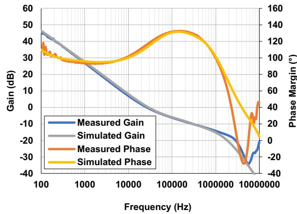
Figure 28.  $-28V_{IN}$ ,  $-24V_{OUT}$ ,  $R_L = 247\Omega$
