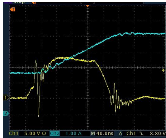
(b) actual Vgs (on package pins)
