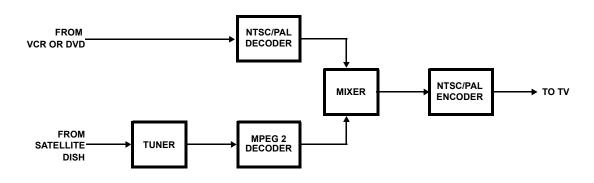
FIGURE 2. TYPICAL VIDEO PATH OF CABLE DIGITAL SETTOP BOX
