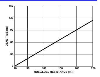
FIGURE 5. MINIMUM DEAD-TIME vs DEL RESISTANCE
