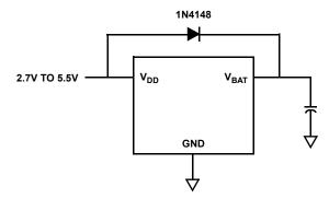
FIGURE 3. SUPER CAPACITOR CHARGING CIRCUIT
