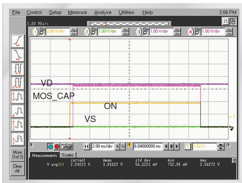
図 6. 短絡電流保護が動作する場合
