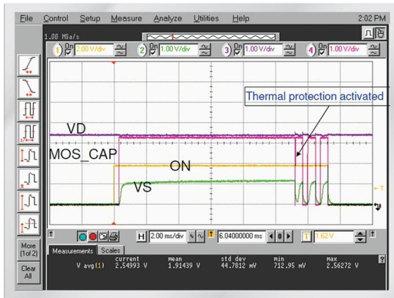
図 5. アクティブ過電流保護の後、過熱保護が動作する場合
