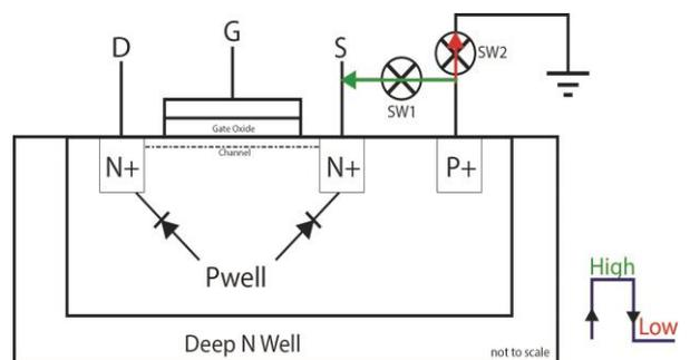
図 11. 基板スイッチングによる逆流防止 FET
