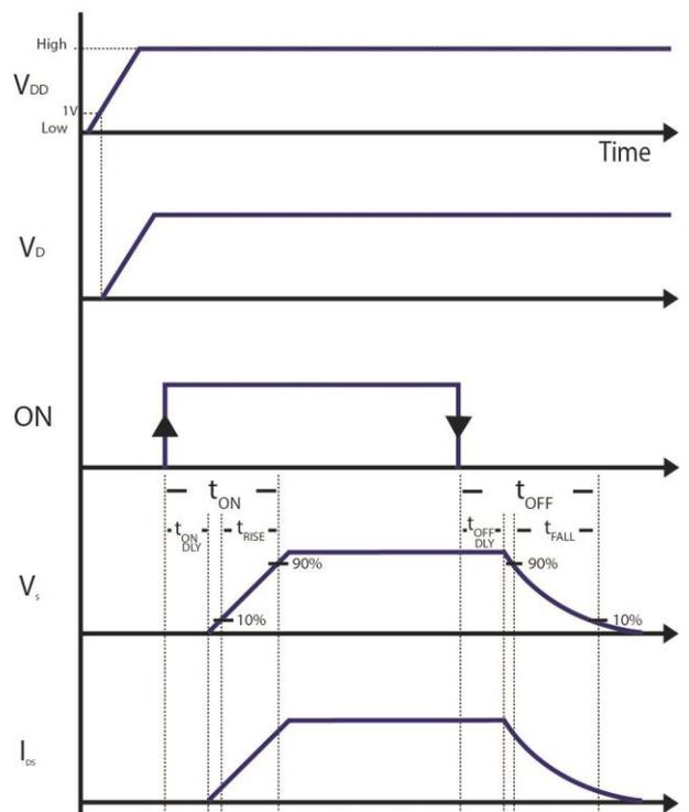
図 4. 一般的な回路動作のタイミングチャート
