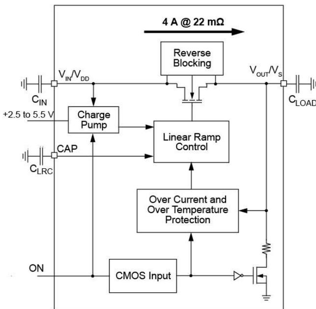
図 1. SLG59610V 集積化パワースイッチ
