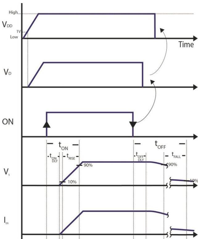
図 3. 一般的な回路動作のタイミングチャート
