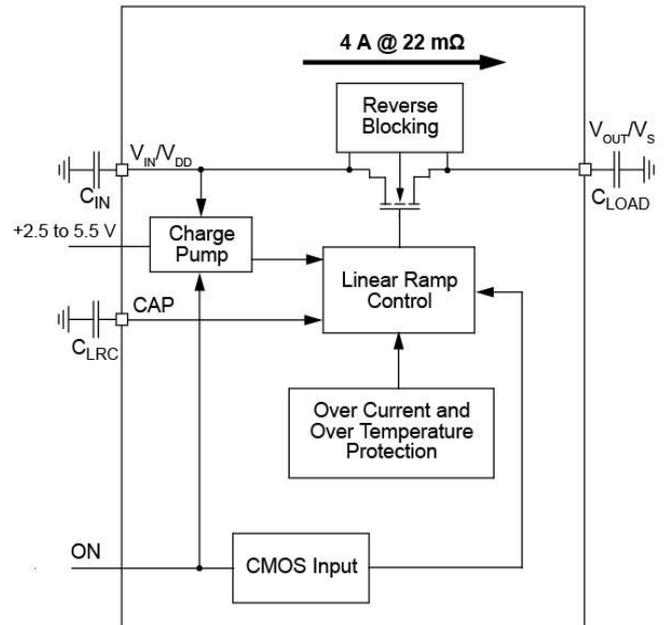
図 2. SLG59611V 集積化パワースイッチ
