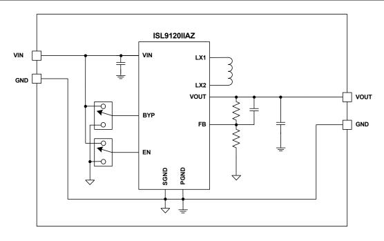
FIGURE 1. ISL9120IIA-EVZ BLOCK DIAGRAM
