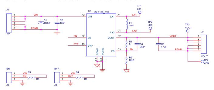
FIGURE 7. ISL9120IIN-EVZ EVALUATION BOARD SCHEMATIC
