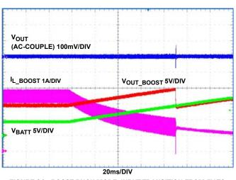
FIGURE 21. BOOST-BUCK MODE, INPUT TRANSITION FROM 5V TO 12V, 2.5A LOAD
