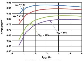
FIGURE 13. CCM EFFICIENCY
