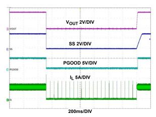
FIGURE 23. SHORT CIRCUIT WAVEFORMS
