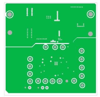
FIGURE 9. SECOND LAYER (SOLID GROUND)
