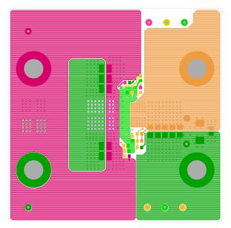
FIGURE 9. BOTTOM LAYER SOLDER SIDE
