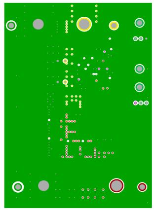
FIGURE 12. SECOND LAYER(SOLID GROUND)
