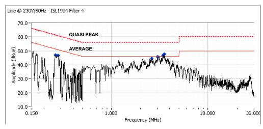
FIGURE 30. LINE AT 230V, 50Hz
