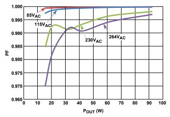
FIGURE 6. POWER FACTOR vs LINE VOLTAGE
