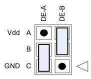
FIGURE 2. JUMPER CONFIGURATION FOR 3dB DE-EMPHASIS
