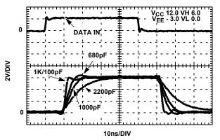
FIGURE 11. DRIVER WAVEFORMS UNDER VARIOUS LOADS
