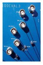
FIGURE 5. HIGH SPEED, TESTER SIDE, DRIVER CONNECTIONS
