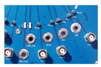
FIGURE 6. LOW FREQUENCY CONNECTORS
