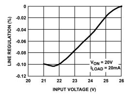
FIGURE 8.  $V_{\mbox{ON}}$  LINE REGULATION
