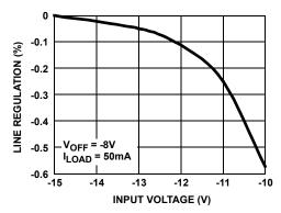
FIGURE 10. V<sub>OFF</sub> LINE REGULATION
