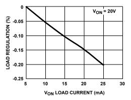
FIGURE 7.  $V_{ON}$  LOAD REGULATION
