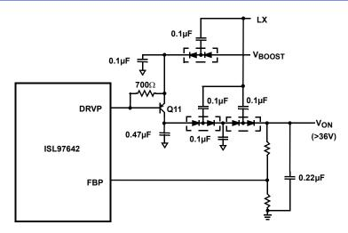
FIGURE 21. THE LINEAR REGULATOR CONTROLS ONE STAGE OF CHARGE PUMP
