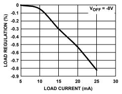
FIGURE 9. V<sub>OFF</sub> LOAD REGULATION
