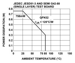
FIGURE 14. PACKAGE POWER DISSIPATION VS AMBIENT TEMPERATURE
