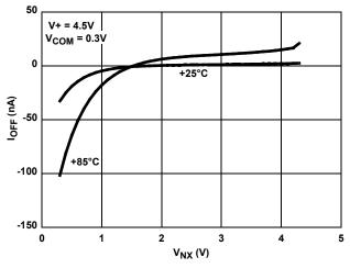
FIGURE 20. OFF LEAKAGE vs SWITCH VOLTAGE
