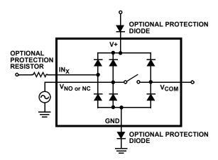
FIGURE 8. OVERVOLTAGE PROTECTION
