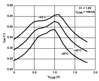
FIGURE 12. ON-RESISTANCE vs SWITCH VOLTAGE
