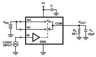
FIGURE 3B. TEST CIRCUIT
