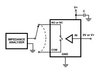
FIGURE 7. CAPACITANCE TEST CIRCUIT
