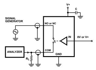
FIGURE 4. OFF ISOLATION TEST CIRCUIT
