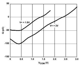
FIGURE 13. CHARGE INJECTION vs SWITCH VOLTAGE
