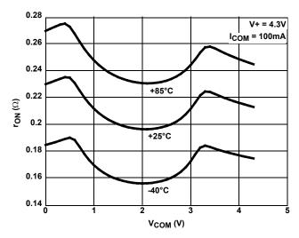
FIGURE 10. ON-RESISTANCE vs SWITCH VOLTAGE
