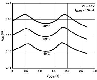
FIGURE 11. ON-RESISTANCE vs SWITCH VOLTAGE
