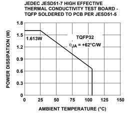
FIGURE 15. PACKAGE POWER DISSIPATION vs AMBIENT TEMPERATURE
