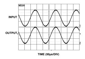
FIGURE 14. OP AMP RAIL-TO-RAIL INPUT/OUTPUT
