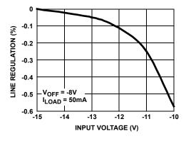
FIGURE 11.  $V_{\mbox{OFF}}$  LINE REGULATION
