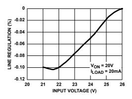
FIGURE 9.  $V_{\mbox{ON}}$  LINE REGULATION
