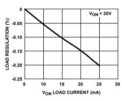
FIGURE 8.  $V_{ON}$  LOAD REGULATION
