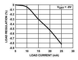
FIGURE 10. V<sub>OFF</sub> LOAD REGULATION
