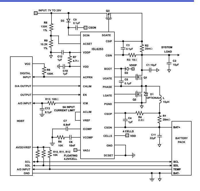
FIGURE 17. TYPICAL APPLICATION CIRCUIT 1
