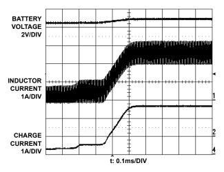
FIGURE 12. CHARGE MODE TRANSITION FROM TRICKLE
