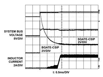
FIGURE 8. AC ADAPTER INSERTION
