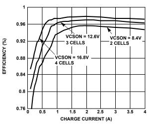
FIGURE 15. EFFICIENCY vs CHARGE CURRENT
