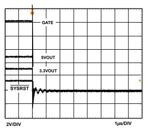
FIGURE 8. SYSRST LOW TO OUTPUT LATCH-OFF
