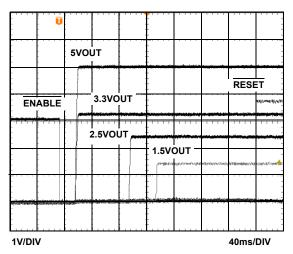
FIGURE 9. ISL6124 SEQUENCED TURN-ON
