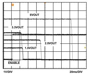
FIGURE 10. ISL6124 SEQUENCED TURN-OFF
