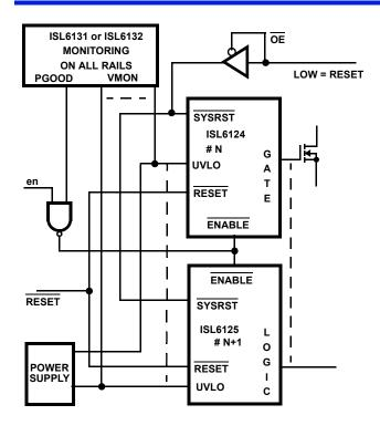
FIGURE 19. ISL612X AND ISL613X VOLTAGE COMPLIANT SEQUENCING BLOCK DIAGRAM
