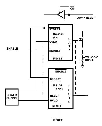
FIGURE 21. MULTIPLE ISL612X SERIAL CONFIGURATION
