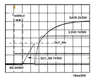
FIGURE 11. ISL6123 SINGLE CHANNEL TURN-ON
