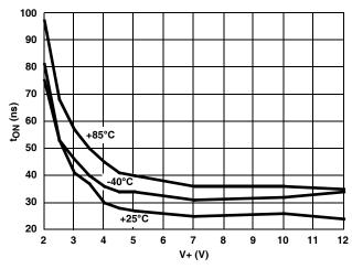
FIGURE 13. TURN-ON TIME vs SUPPLY VOLTAGE
