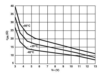
FIGURE 9. ON-RESISTANCE vs SUPPLY VOLTAGE
