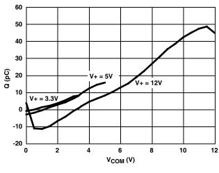
FIGURE 12. CHARGE INJECTION vs SWITCH VOLTAGE
