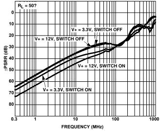
FIGURE 18. ±PSRR vs FREQUENCY
