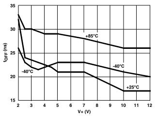
FIGURE 14. TURN-OFF TIME vs SUPPLY VOLTAGE
