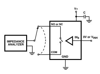
FIGURE 7. CAPACITANCE TEST CIRCUIT
