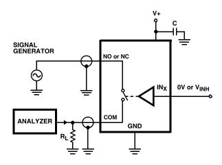
FIGURE 4. OFF ISOLATION TEST CIRCUIT
