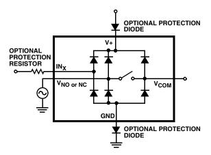
FIGURE 8. OVERVOLTAGE PROTECTION
