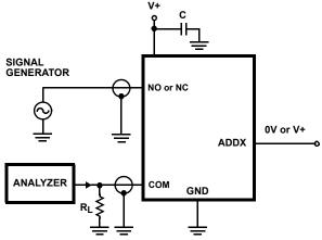
FIGURE 4. OFF ISOLATION TEST CIRCUIT
