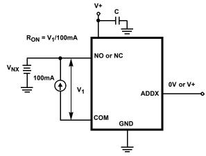
FIGURE 5. RON TEST CIRCUIT
