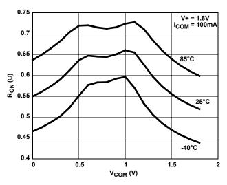
FIGURE 11. ON RESISTANCE vs SWITCH VOLTAGE
