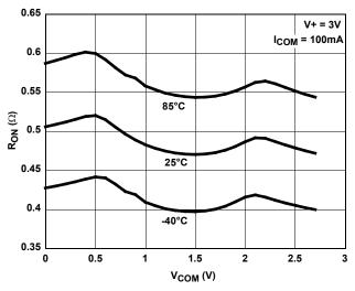
FIGURE 10. ON RESISTANCE vs SWITCH VOLTAGE
