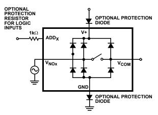
FIGURE 8. OVERVOLTAGE PROTECTION
