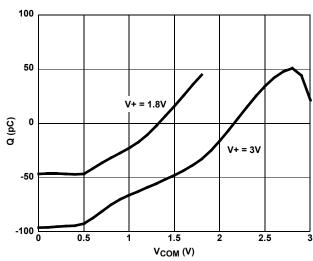
FIGURE 12. CHARGE INJECTION vs SWITCH VOLTAGE
