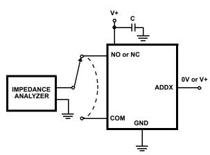
FIGURE 7. CAPACITANCE TEST CIRCUIT
