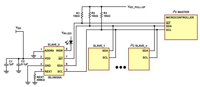
FIGURE 5. ISL29028A TYPICAL CIRCUIT
