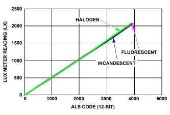
FIGURE 9. ALS LINEARITY OVER 3 LIGHT SOURCES (2000 LUX RANGE)
