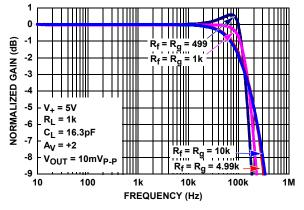
FIGURE 1. GAIN vs FREQUENCY vs FEEDBACK RESISTOR VALUES  ${\rm R_{f}}/{\rm R_{g}}$
