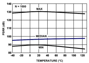
FIGURE 32. PSRR vs TEMPERATURE, V<sub>+</sub>, V<sub>-</sub> = ±1.2V TO ±2.75V
