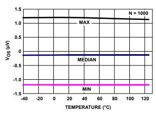
FIGURE 22. V<sub>OS</sub> (SOT PKG) vs TEMPERATURE, V<sub>IN</sub> = 0V, V<sub>+</sub>, V<sub>-</sub> =  $\pm 2.75$ V
