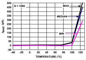
FIGURE 26. I<sub>BIAS</sub>- vs TEMPERATURE, V<sub>+</sub>, V<sub>-</sub> = ±2.5V
