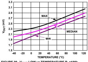
FIGURE 39. V<sub>OUT</sub> LOW vs TEMPERATURE R<sub>L</sub>=100k, V<sub>+</sub>, V<sub>-</sub> =  $\pm$ 2.5V
