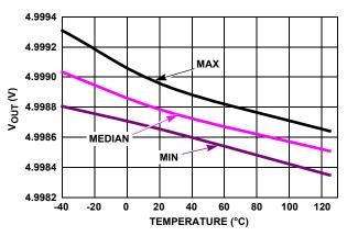
FIGURE 37. V<sub>OUT</sub> HIGH vs TEMPERATURE R<sub>L</sub> = 100k, V<sub>+</sub>, V<sub>-</sub> =  $\pm 2.5V$
