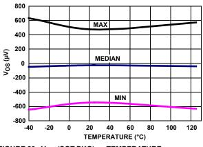
FIGURE 23.  $V_{OS}$  (SOT PKG) vs TEMPERATURE  $V_{IN}$  = 0V, V<sub>+</sub>, V<sub>-</sub> = ±2.75V
