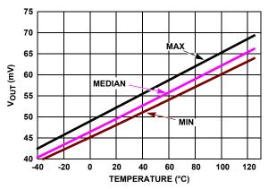
FIGURE 38. V<sub>OUT</sub> LOW vs TEMPERATURE R<sub>L</sub> = 1k,  $V_+, V_- = \pm 2.5V$
