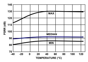
FIGURE 35. PSRR vs TEMPERATURE, V<sub>+</sub>, V<sub>-</sub> = ±1.2V TO ±2.75V
