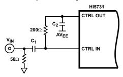
FIGURE 24. HIGH FREQUENCY MULTIPLYING BANDWIDTH CIRCUIT
