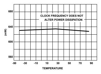
FIGURE 4. TYPICAL POWER DISSIPATION OVER TEMPERATURE
