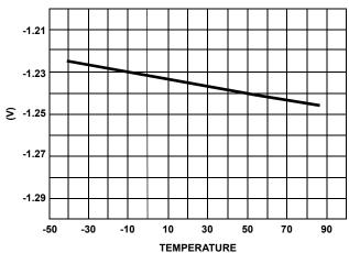
FIGURE 5. TYPICAL REFERENCE VOLTAGE OVER TEMPERATURE
