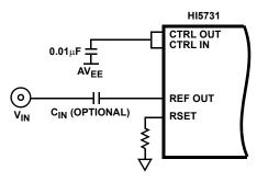
FIGURE 23. LOW FREQUENCY MULTIPLYING BANDWIDTH CIRCUIT
