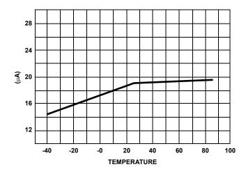
FIGURE 8. OFFSET CURRENT OVER TEMPERATURE
