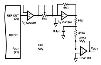
FIGURE 27. BIPOLAR OUTPUT CONFIGURATION
