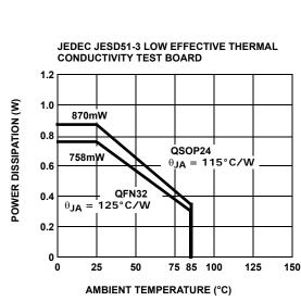
FIGURE 21. PACKAGE POWER DISSIPATION vs AMBIENT TEMPERATURE
