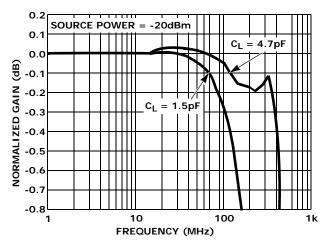
FIGURE 5. 0.1dB GAIN vs FREQUENCY
