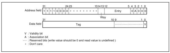
Figure 7.5 Memory-Mapped IC Address Array
