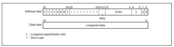
Figure 7.6 Memory-Mapped IC Data Array
